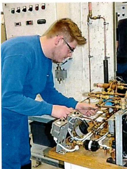
In der Ausbildung und in Weiterbildungskursen wird die Lecksuche an kältemittelführenden Anlagen gelehrt, hier die direkte Methode mit einem elektronischen Lecksuchgerät.
